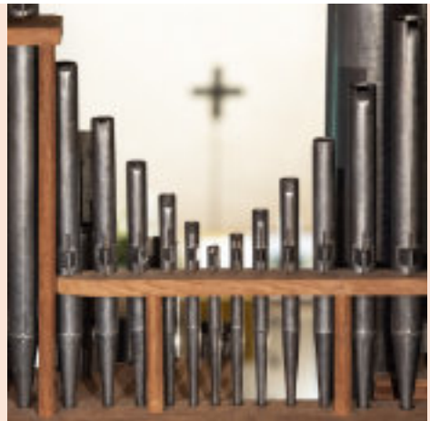
Pfeifen aus Blei - gegossen und gehämmert Foto Stig Bursche.
